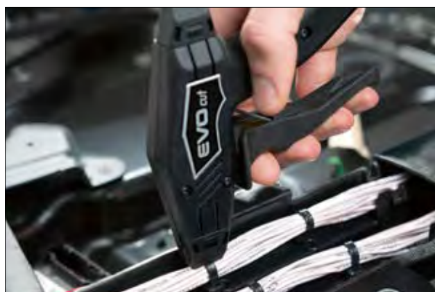
Le collier peut être coupé à n'importe quel endroit de la bande.
