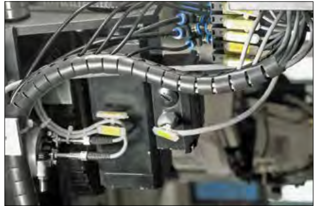
Une protection accrue et plus flexible des dérivations quel que soit le point de sortie sur la gaine.
