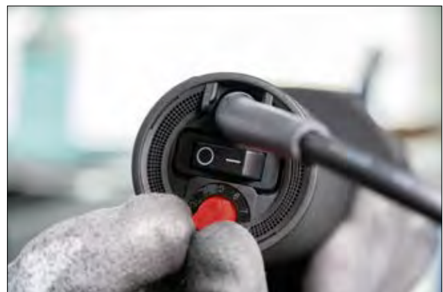
Réglage de la température de fonctionnement du H6100.
