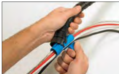
Placer l'extrémité de la gaine dans l'outil.
