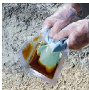
Door middel van druk wordt de middelste sealnaad tussen giethars en hardercomponent geopend.
