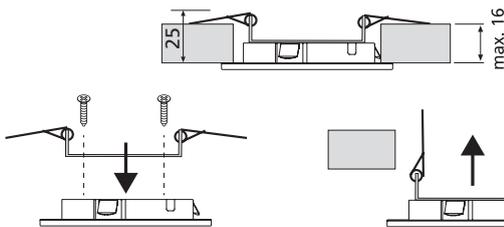
Schenkelfedern nach oben drücken. Leuchte in die Einbauöffnung einsetzen.
