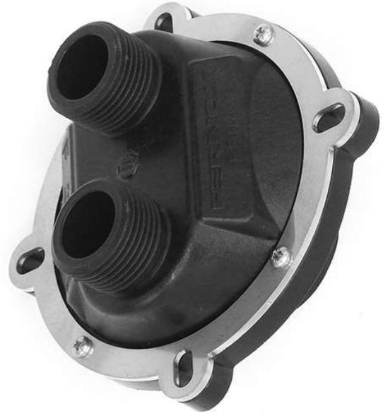
Der Powerflow Pump Head Adapter ermöglicht den einfachen Anschluss einer Powerspülungsmaschine an Zentralheizungssysteme über den Körper der Umwälzpumpe und eignet sich besonders für Brennwertkessel mit eingebauten Zirkulatoren. Dieses Produkt spart Zeit vor Ort und ist sehr einfach zu bedienen, was eine schnellere und effizientere Reinigung ermöglicht.
